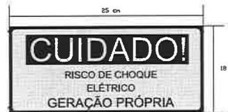
[1] Junto ao padrão de entrada de energia , próximo a caixa de medição/proteção, será instalada uma placa de advertência com os seguintes dizeres: "CUIDADO- RISCO DE CHOQUE ELÉTRICO - GERAÇÃO PRÓPRIA"
