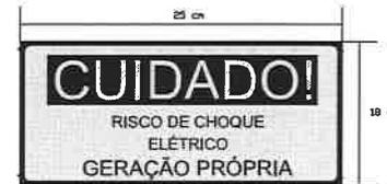
[1] Junto ao padrão de entrada de energia, próximo a caixa de medição/proteção, será instalada uma placa de advertência com os seguintes dizeres: "CUIDADO- RISCO DE CHOQUE ELÉTRICO - GERAÇÃO PRÓPRIA"
